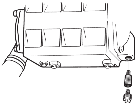
TAMD63: Zinkanod i värmeväxlarens främre gavellock
